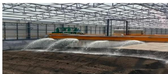
รูปภาพที่ 10. สเปรย์น้ำกากส่าและน้ำหมักจุลินทรีย์ (EM)
